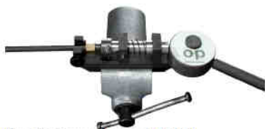
Praska warsztatowa 15MAN Osadzanie pierścieni: 6 (S) ÷ 15mm (L) Materiał: AISI 316 TI - ST 37.4 Mocowanie: np. w imadle; długość dźwigni: 80cm; masa: 12kg, wym.: 285x105x106mm
