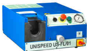
US-FL - osadzanie pierścieni 24° i kielichowanie 37°, silnik elektryczny 400V 3~
