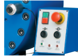
Układ sterujący "EL": mikrometr + przyciski sterujące
